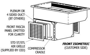
A PLENUM OR 4 SIDED TUNNEL (MADE FROM MDF, PLYWOOD OR NILFLAM TYPE MATERIAL) MUST BE FITTED BETWEEN THE REAR FACE OF THE CUSTOMER SIDE FASCIA PANEL AND THE FRONT FACE OF THE COMPRESSOR CRADLE, AROUND THE AIR INTAKE CUT-OUT, TO STOP THE RE-CIRCULATION OF HOT AIR FROM THE COMPRESSOR. SILICON SEAL AROUND EDGES TO ENSURE THERE ARE NO AIR GAPS.
