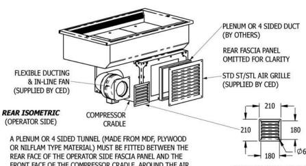
FRONT FACE OF THE COMPRESSOR CRADLE, AROUND THE AIR INTAKE CUT-OUT, TO STOP THE RE-CIRCULATION OF HOT AIR FROM THE COMPRESSOR. SILICON SEAL AROUND EDGES TO ENSURE THERE ARE NO AIR GAPS.
