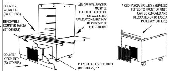
\*\* A PLENUM OR 4 SIDED TUNNEL (MADE FROM MDF, PLYWOOD OR NILFLAM TYPE MATERIAL) MUST BE FITTED BETWEEN THE REAR FACE OF THE CUSTOMER SIDE FASCIA PANEL AND THE FRONT FACE OF THE PATISSERIE, AROUND THE AIR INTAKE CUT-OUT, TO STOP THE RE-CIRCULATION OF HOT AIR FROM THE COMPRESSOR, SILICON SEAL AROUND EDGES TO ENSURE THERE ARE NO AIR GAPS.
